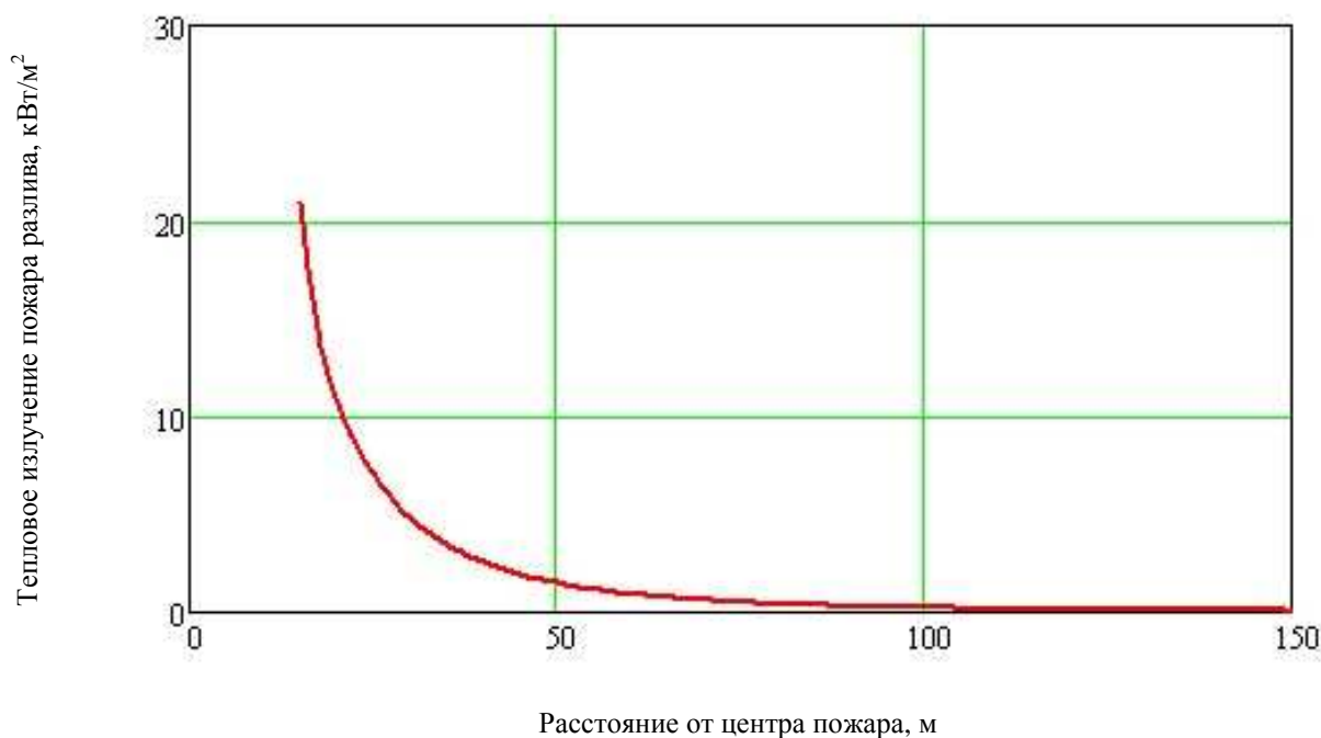
Зависимость величины теплового излучения пожара разлива от расстояния
